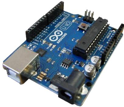
Figura 13: Arduino do sistema de medição
