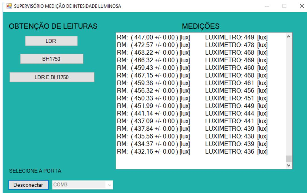
Figura 27 Aplicação de supervisão das medidas dos sensores
