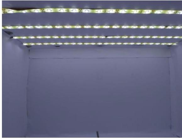
Figura 32 Fitas de LED do ambiente de calibração
