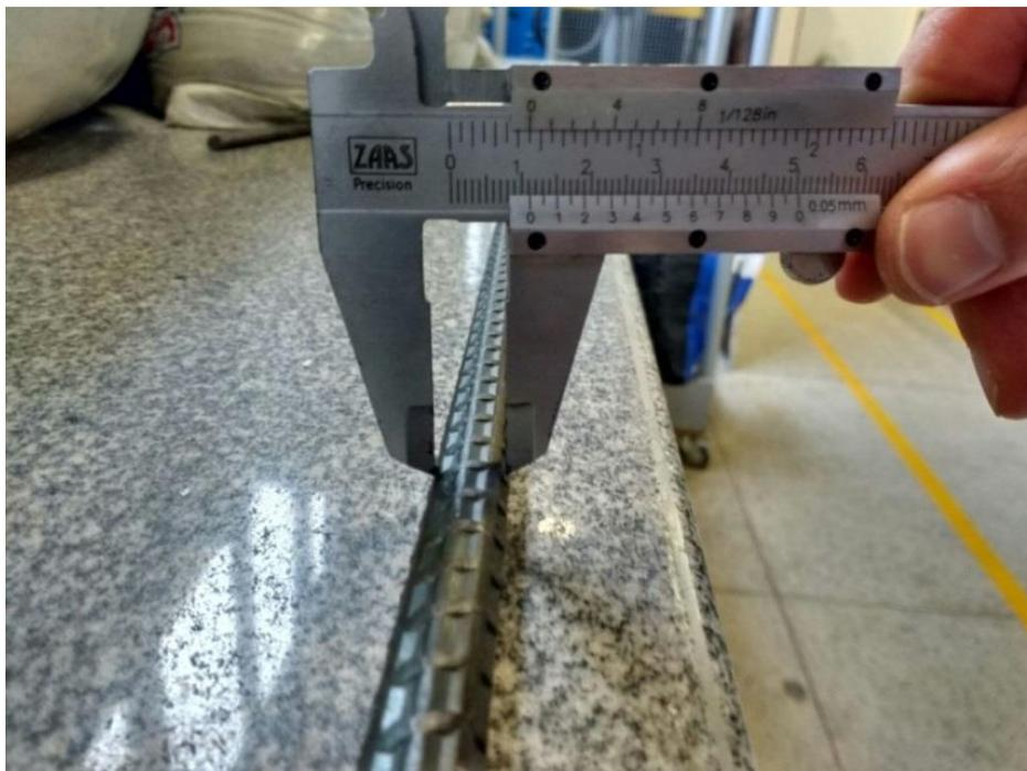
Figura 5.12: Medição do ponto mais baixo da altura das nervuras
