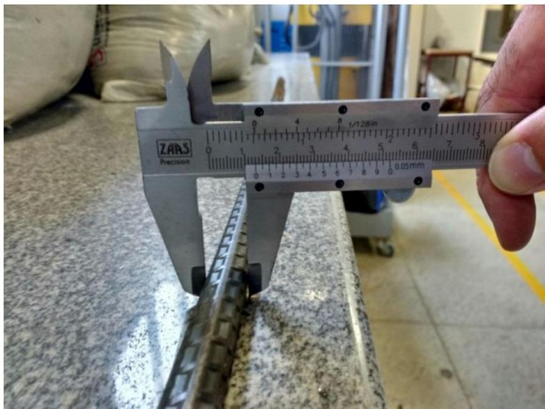
Figura 5.13: Medição do ponto mais alto da altura das nervuras
