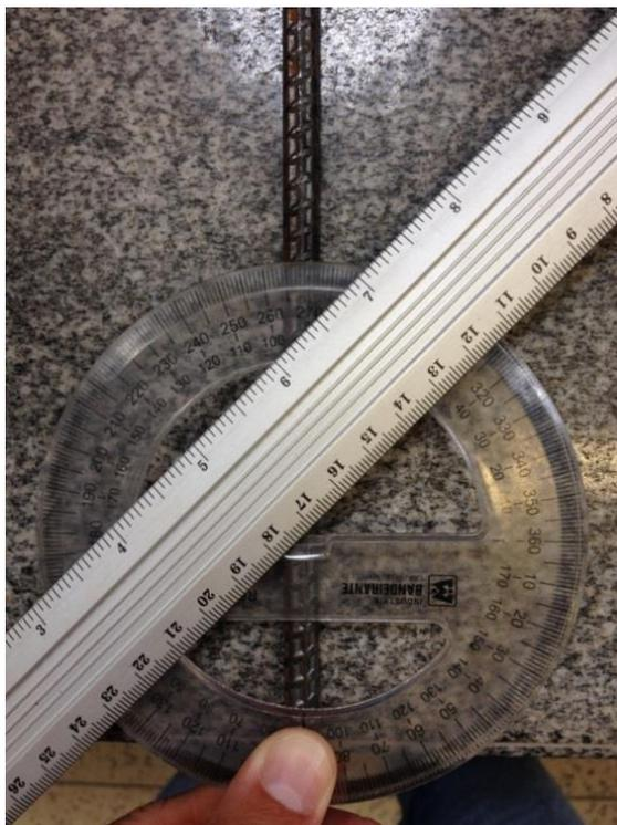
Figura 5.9: Leitura do ângulo de inclinação das nervuras
