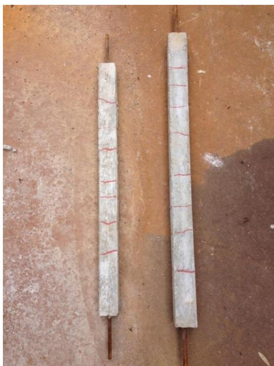
Figura 5.34: Fissuração em tirantes de concreto natural de 20 MPa
