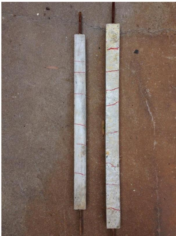
Figura 5.33: Fissuração em tirantes de concreto com escória de 20 MPa
