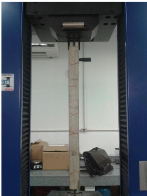
Figura 5.28: Ensaio para determinação do coeficiente de conformação superficial de um tirante de concreto armado.
