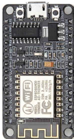
Figura 3: Microcontrolador ESP8266 NodeMCU
