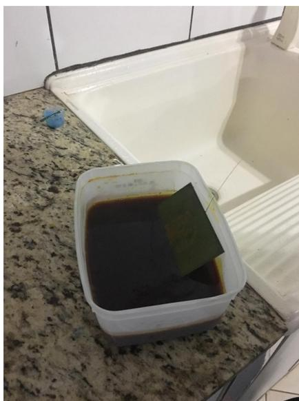
Figura 28: Corrosão da Placa
