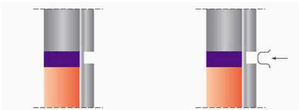
Figura 5.7: execução da limpeza já cavidade e da membrana impermeabilizante, respectivamente. Fonte: Ribeiro e Barros (2010).
