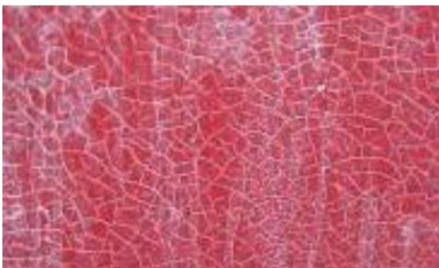
Figura 2.10: Gretamento da placa cerâmica. Fonte: Revista Construindo. Belo Horizonte: EEUFMG, v. 4, n. 1, Jan/Jun. 2012.
