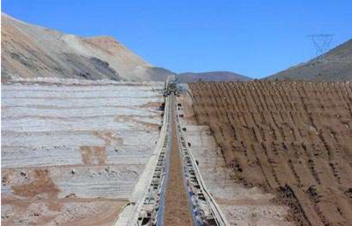
Figura 24 - Empilhamento a seco de rejeitos utilizando correias transportadoras na mina La Coipa, no Chile (ENGELS, 2006).
