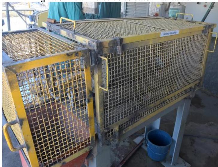
Para essa primeira etapa de testes foram usadas as alíquotas individuais de cada subgrupo. As condições operacionais básicas, para estes testes foram: rotação de 33 rpm (40% da velocidade crítica), considerando um tempo de moagem de 15 minutos e uma porcentagem de sólidos de 50%. A Tabela 4 mostra a sequência dos testes realizados e os parâmetros variados em cada um desses testes.
