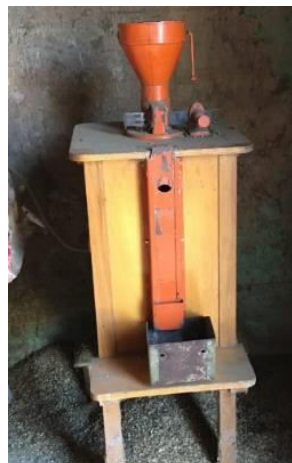
Figura 14 - Descascador de café
