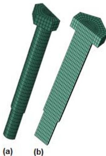
Figura 3.4 - Malha utilizada para o parafuso: (a) detalhe representando o lado externo do parafuso; (b) representação da malha utilizada no corpo do parafuso.
