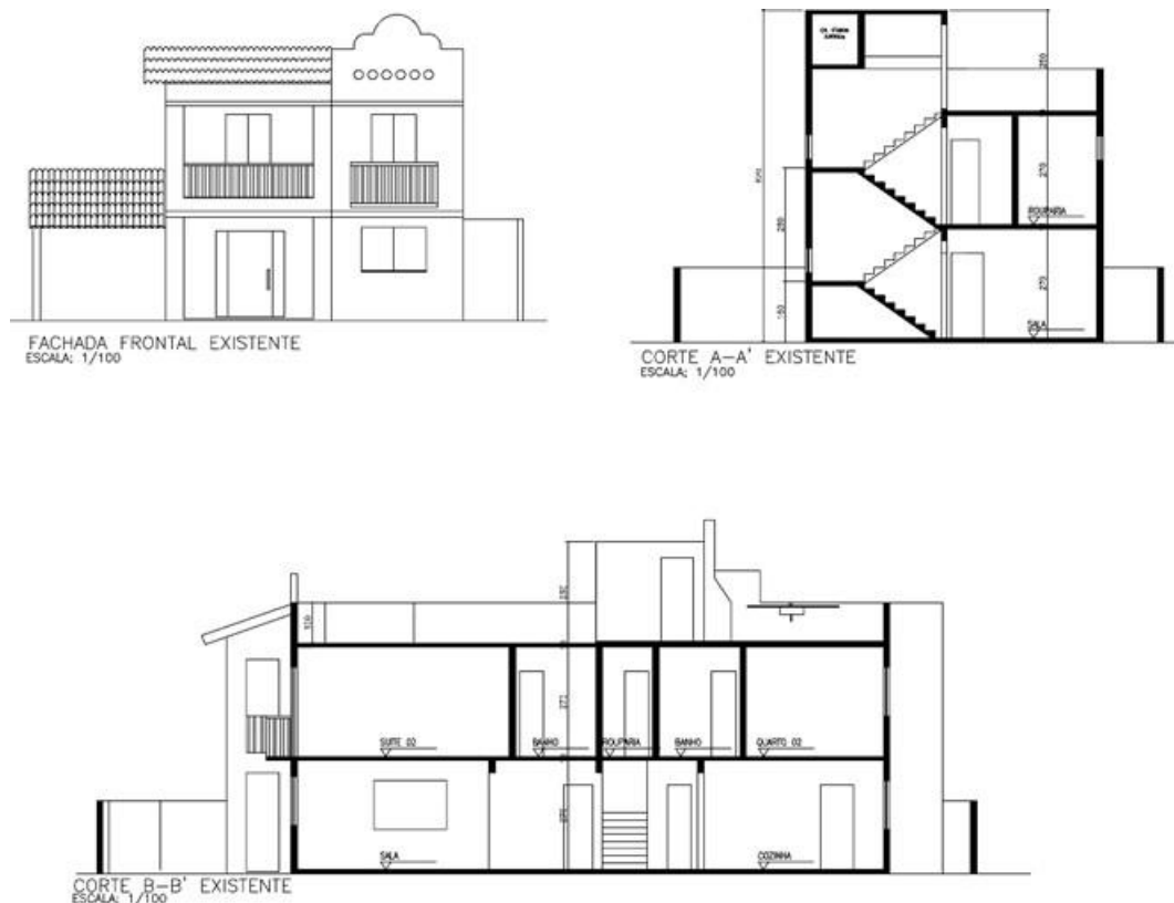
Figura 3.8 – Cortes e fachada frontal da edificação
