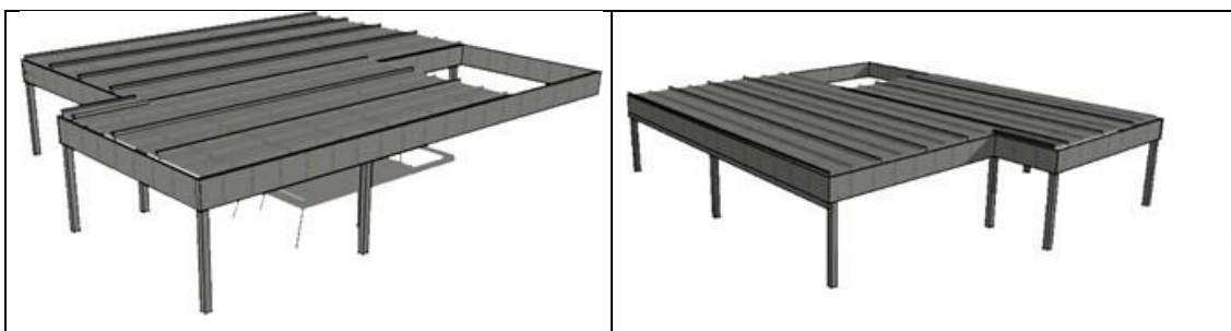
Figura 3.16 – Perspectivas da cobertura estruturada em aço
