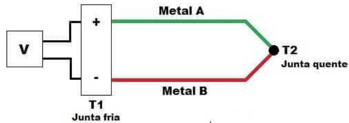
Figura 2.11 – Princípio de funcionamento do termopar
