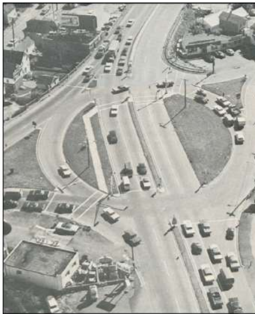
Figura 8 - Interseção tipo Rótula Vazada. Fonte: Brasil (2005)
