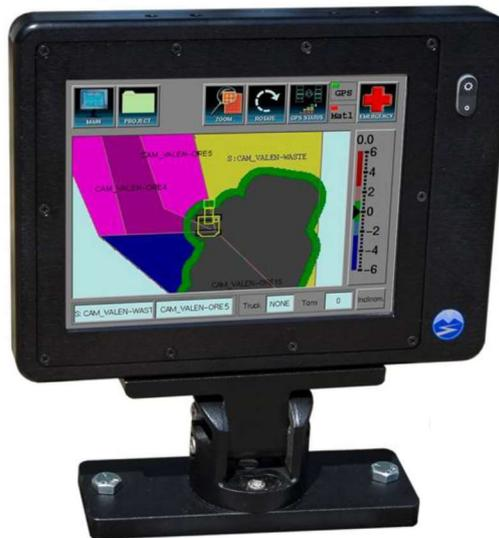
Figura 2 - Imagem do computador de bordo localizado nos equipamentos de carga e transporte da mina.
