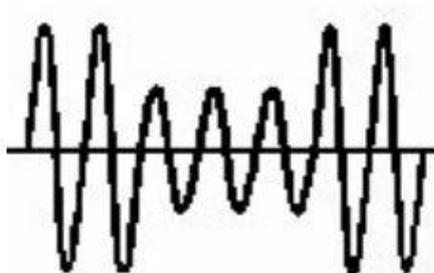
**Figura 4: Afundamento de tensão**
