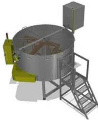
Figura 15: Ilustração do misturador utilizado para fazer a mistura de areia e coque.
