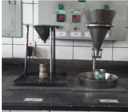
Figura 18 – Aparato utilizado na análise de densidade solta.
