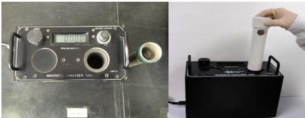
Figura 20 – Equipamento utilizado na análise de material ferromagnético.
