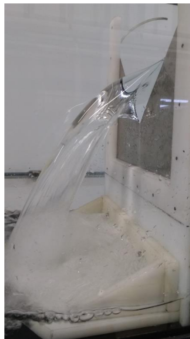
Figura 5.4 – Vertedor triangular – (esq.) vista frontal; (dir.) vista lateral ( \alpha = 90^\circ e P = 200 mm)
