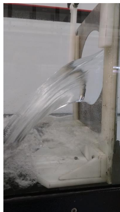
Figura 5.5 – Vertedor circular – (esq.) vista frontal; (dir.) vista lateral ( D = 200 mm e P = 250 mm)
