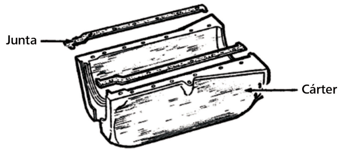
Figura 9 – Cárter e junta de vedação [21].
