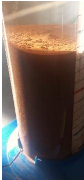
Figura 20. Teste de sedimentação da polpa de 36% preparada pelo método A, sem a presença de flocos.
