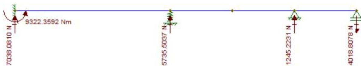
Figura 57: Reações de apoio do modelo 1
