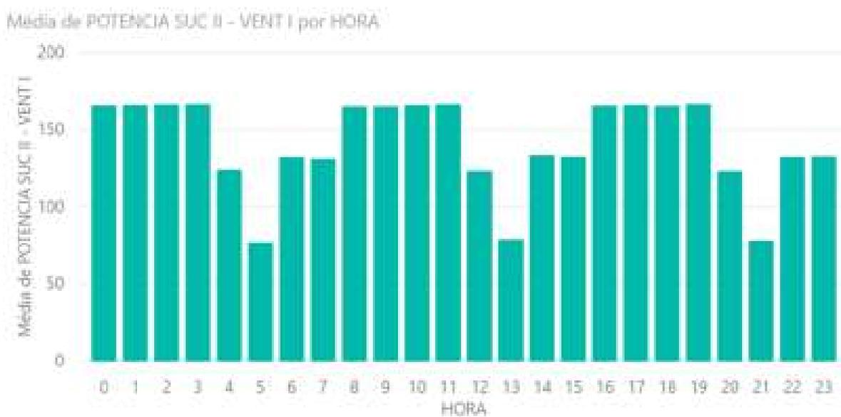
Figura 19: Gráfico da média de consumo energético em kWh ao longo das 24 horas do dia dos ventiladores do Sucuri II durante o mês julho de 2018.
