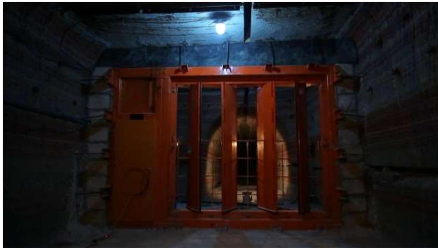
Figura 4: Regulador de vazão para galerias de ventilação (Fonte: Kashnikov, sd).
