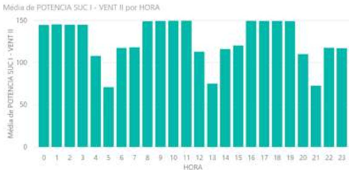
Figura 18: Gráfico da média de consumo energético em kWh ao longo das 24 horas do dia dos ventiladores do Sucuri I durante o mês julho de 2018.
