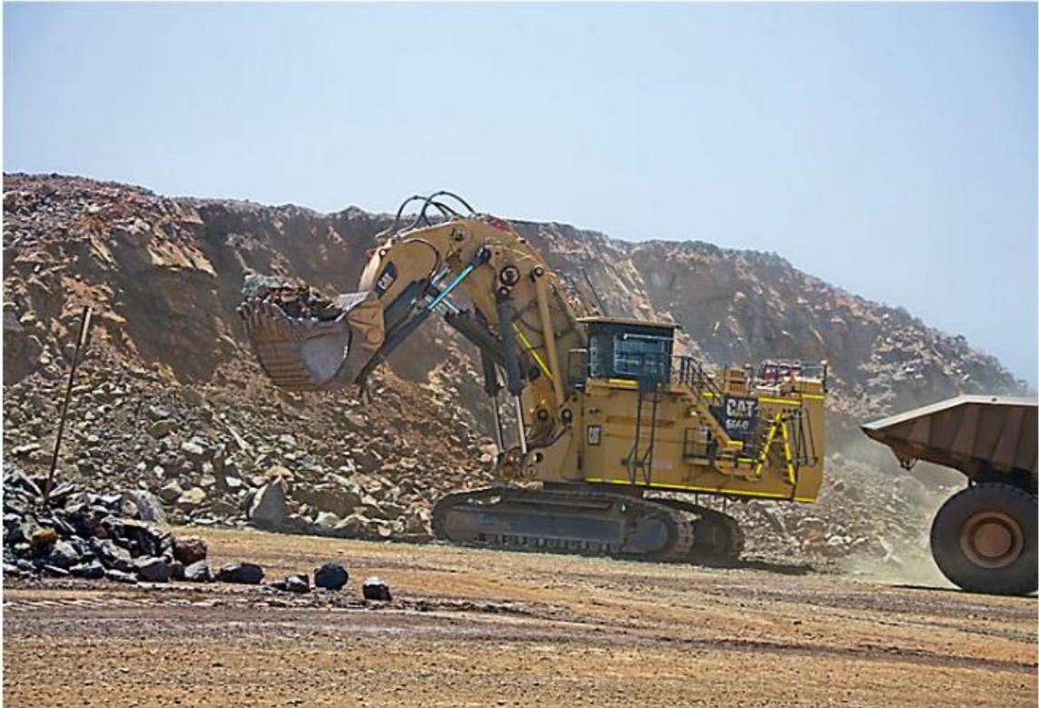
*Figura 5 Escavadeira Hidráulica Shovel Caterpillar 6060B*
