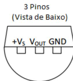
FIGURA 0.17 - Pinagem do sensor de temperatura LM35.
