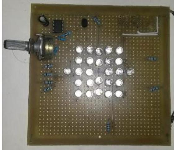
FIGURA 0.16 - Placa experimental de fonte luminosa com oscilador.
