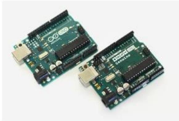
FIGURA 0.21 - Plataforma didática Arduino UNO.
