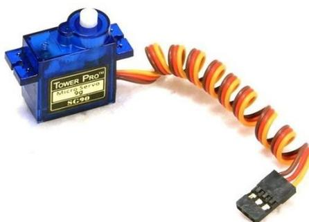
FIGURA 0.20 - Servo Motor 9g implementado como atuador.
