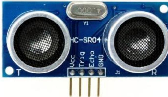
FIGURA 0.18 -Sensor e emissor ultrassônico HC-SR04.
