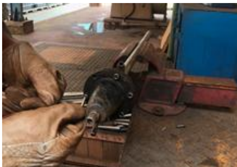
Figura 9-Operador desmontando o aerador na oficina
