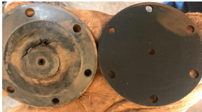
Figura 12-À esquerda diafragma estourado. À direita, diafragma em bom estado
