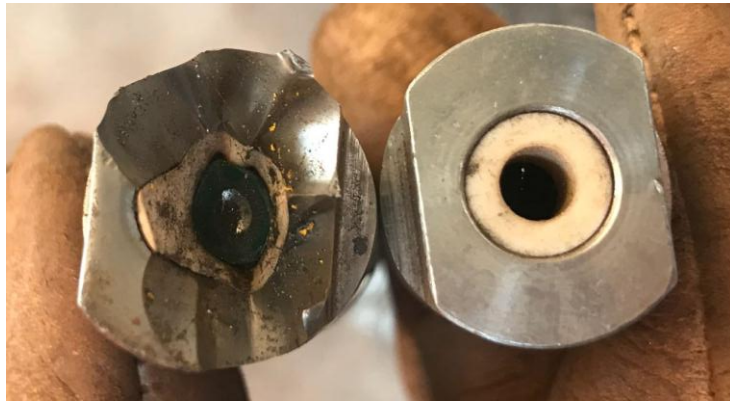
Figura 12-À esquerda diafragma estourado. À direita, diafragma em bom estado
