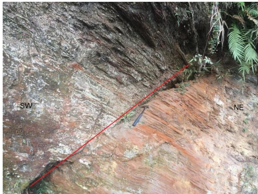
Figura 9.7 - Fratura da família J6 apresentando baixo mergulho vista em corte lateral do maciço. (Observação em P6 no mapa de pontos – Fig 7.1)
