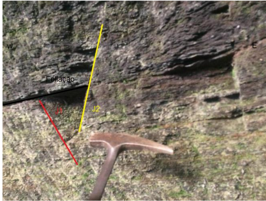
Figura 9.3 - Feição de movimento em cunha descrito na imagem anterior observado lateralmente. (Observação em P1 no mapa de pontos – Fig 7.1)
