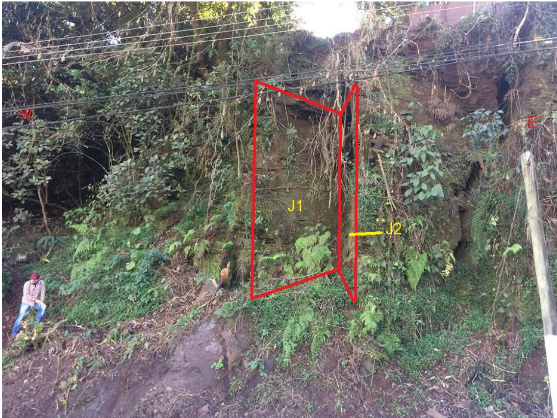
Figura 9.14 - Feição de movimento em cunha em maior escala, caracterizado pelas famílias J1, J2 e pelo plano de foliação. As cunhas são de aproximadamente 10m no itabirito, bairro Morro Santana. (Observação em P11 no mapa de pontos – Fig 7.1)
