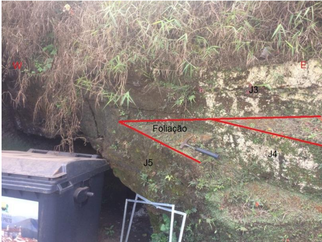
Figura 9.6 - Foliação e famílias de juntas J3, J4 e J5 em afloramento de itabirito. (Observação em P2 no mapa de pontos – Fig 7.1)
