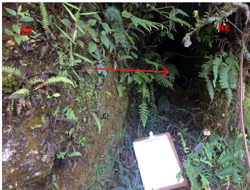
Figura 9.16 - Corte de antiga galeria para extração do ouro feito acompanhando a família J2. (Observação em P12 no mapa de pontos – Fig 7.1)
