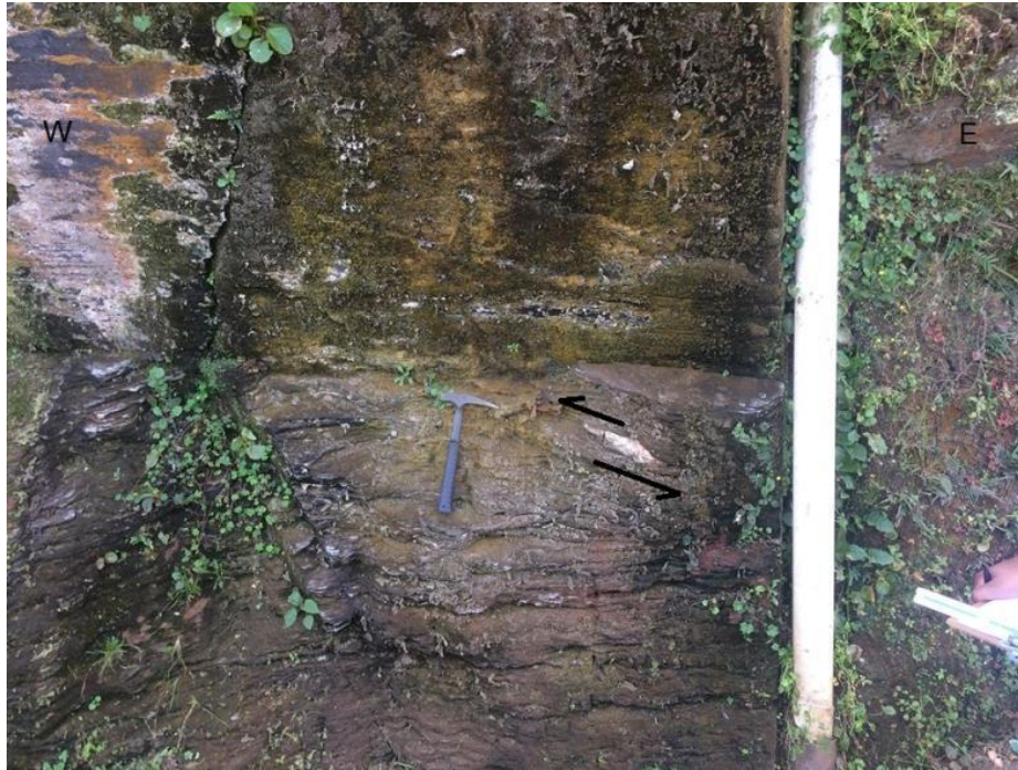
Figura 7.6 - Feição estrutural com quartzo em afloramento da figura anterior exibindo cinemática. (Observação em P1 no mapa de pontos – Fig 7.1)
