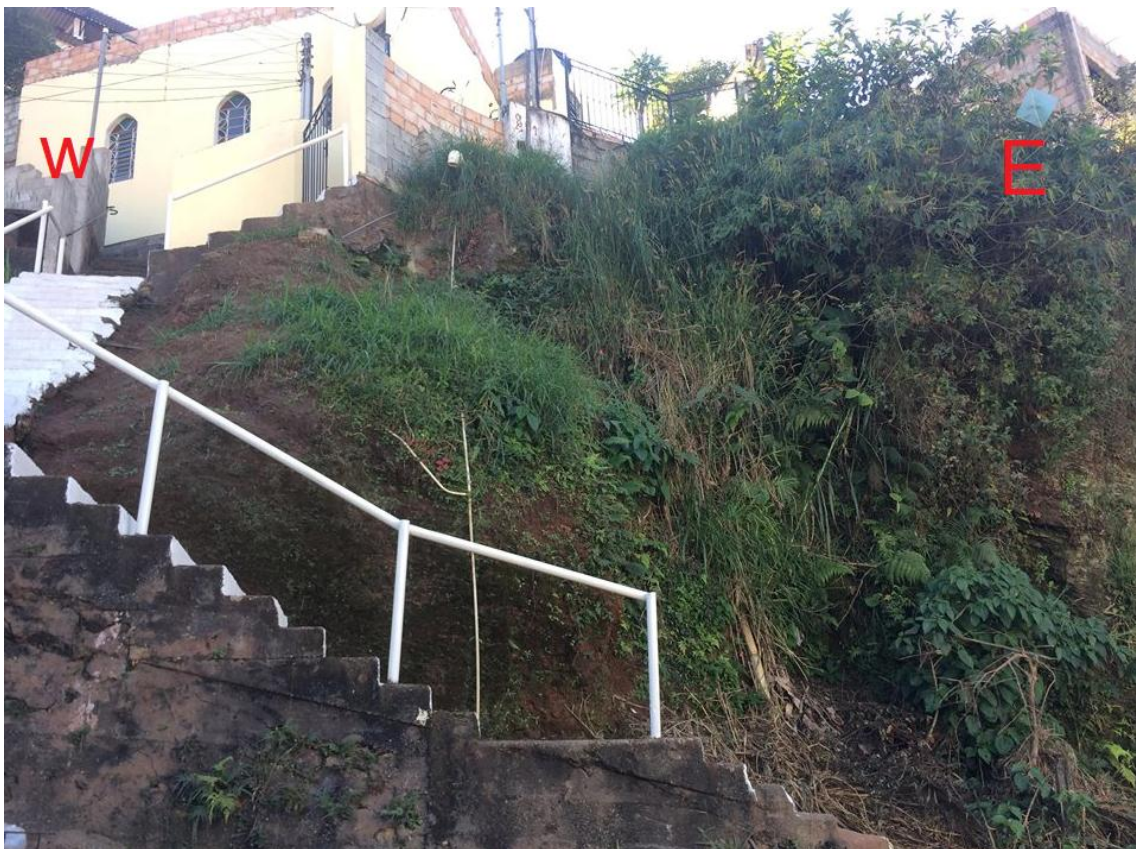
Figura 9.8 - O sobrepeso gerado pela ocupação urbana é fator condicionante para caracterizar a estabilidade do maciço rochoso, além disso, a existência das residências dificulta a caracterização e estudo do maciço no eixo ortogonal ao plano da foliação. (Observação em P7 no mapa de pontos – Fig 7.1)
