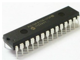
Figura 37. Imagem e esquema de pinout do PIC16F873
