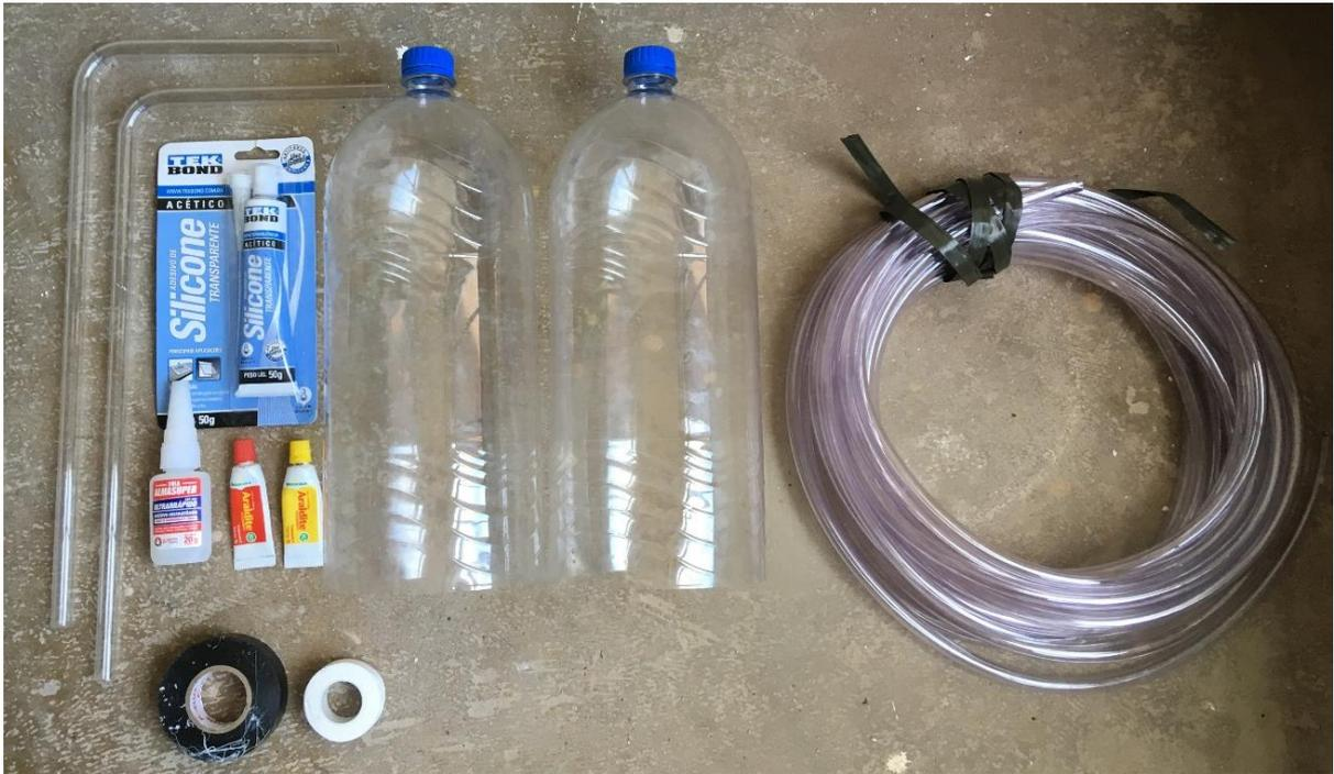
**Figura A1.3:** Material utilizado para a construção de um dos modelos de Lei de Darcy. Foram construídos dois modelos de Lei de Darcy, sendo um preenchido por areia de granulometria média, segundo tabela 1.2 e o segundo preenchido por areia de granulometria fina, segundo tabela 1.2.
