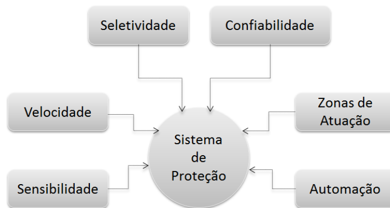
Figura 8- Critérios de desempenho do sistema de proteção
