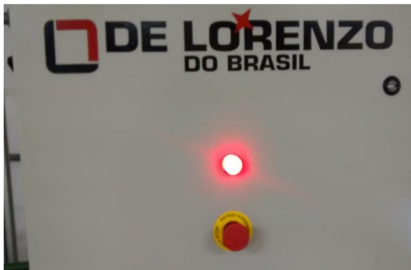
Figura 4.23: Sinal luminoso do sistema de alarme.
