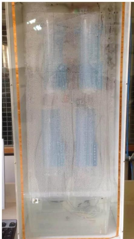
**Figura 40 - Bancada com Alta Concentração de Umidade Condensada**
