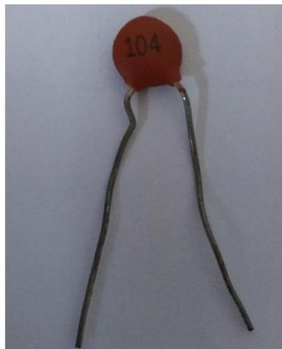
**Figura 14 - Capacitor de Cerâmica de 100 nF**
