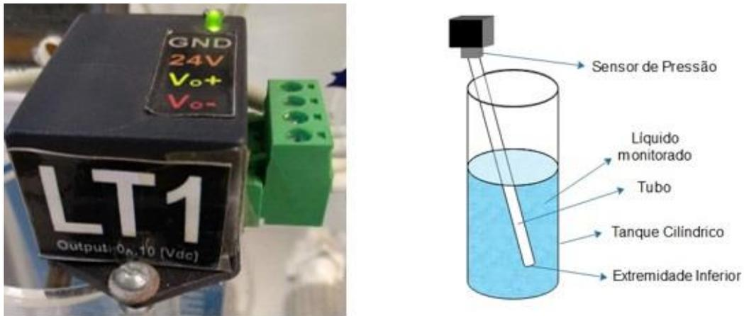
**Figura 5 - Sensor de Pressão com Mangueira Imersa**
