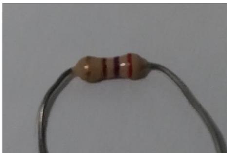
**Figura 13 - Resistor de Carbono**
