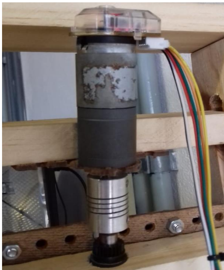
Figura 3.16 – Motor CC com encoder e redução utilizados na montagem
