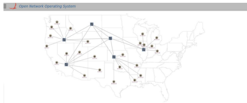
Figura 5 – Topologia criada pelo Mininet exibida na interface do ONOS
