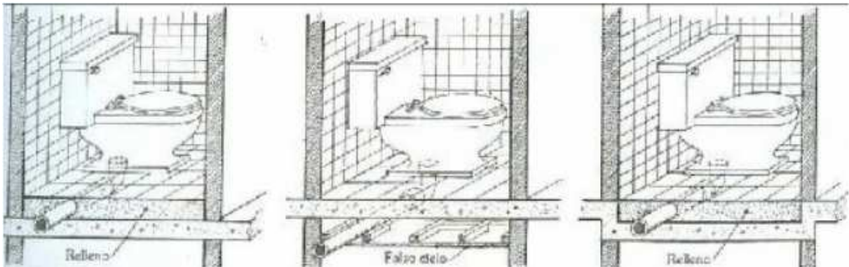
Figura 2.10 - Piso espesso, rebaixo de forro e rebaixo de laje, respectivamente, para instalações hidráulicas
