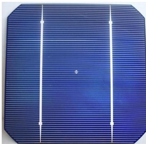
Figura 2.4 – Célula de Silício Monocristalino
