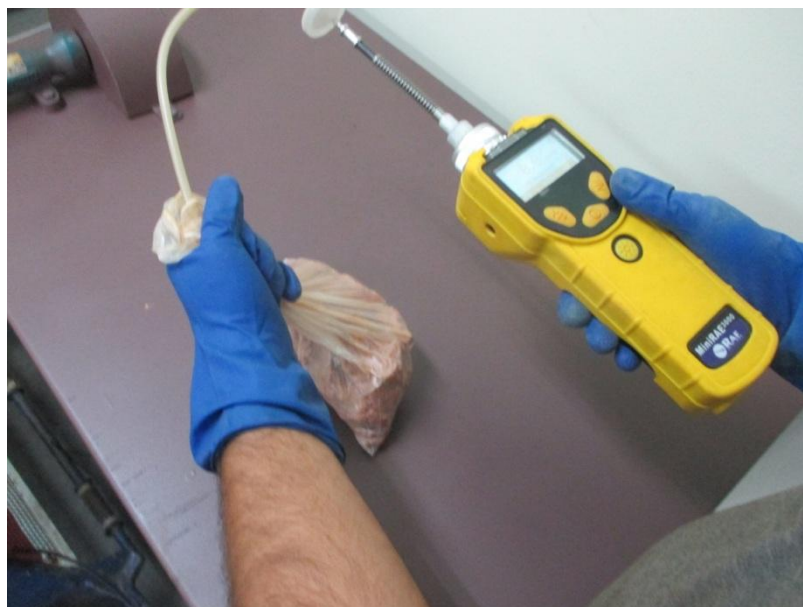
Figura 20 – Medição instantânea de COV Fonte: Elaborada pelo autor
