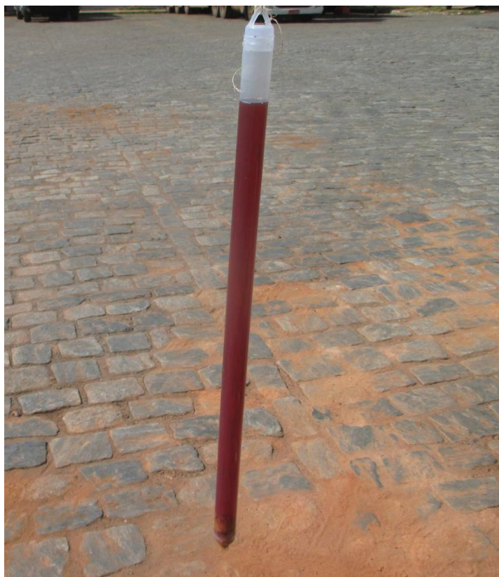
Figura 21 – Coleta de água utilizando o bailer – fase livre Fonte: Elaborada pelo autor
