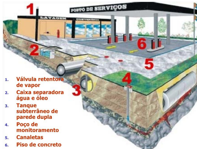
Figura 1 – Modelo esquemático típico de um posto revendedor. Fonte: FOGAÇA (2015).
