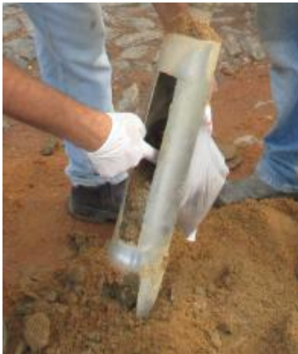
Figura 19 – Coleta das amostras de solo Fonte: Elaborada pelo autor
