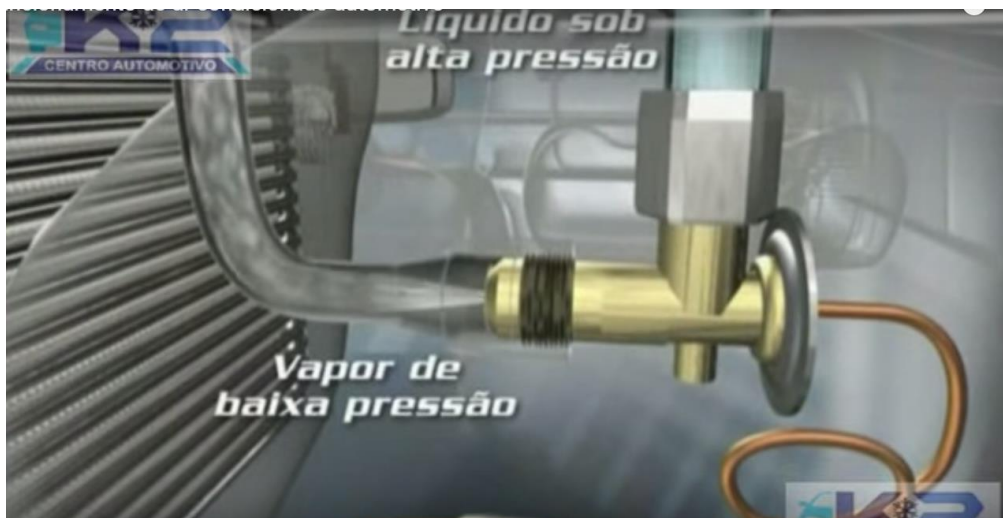
Figura 2-6 – Válvula de expansão. Funcionamento da válvula
