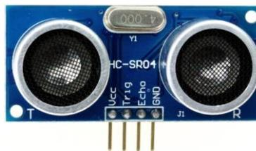
**Figura 3.20** Módulo ultrassônico HC-SR04
