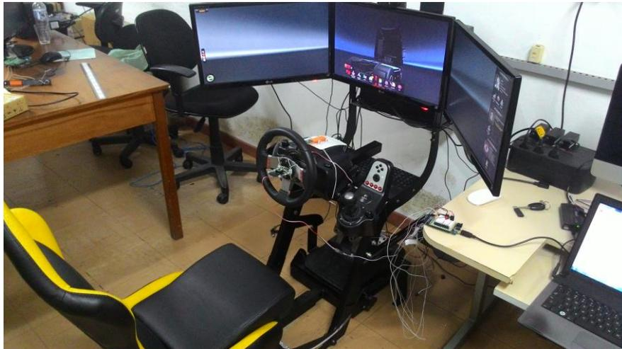
**Figura 4.1 Simulador utilizado como ambiente de testes**
