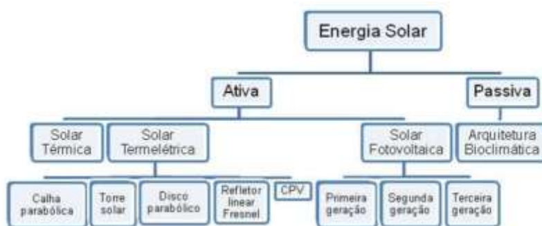
Figura 2.2 - Distribuição do aproveitamento solar. (COMPANHIA ENERGÉTICA DE MINAS GERAIS, 2012)
