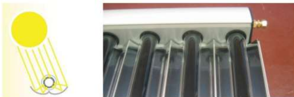
Figura 2.14 - Esquema de funcionamento e vista ampliada de um coletor CPC (OBSERVATÓRIO DE ENERGIAS RENOVÁVEIS PARA A AMÉRICA LATINA E CARIBE - ONUDI).
