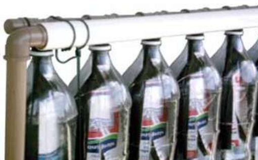
Figura 2.11 - Coletor alternativo com cobertura (CELESC, 2009).
