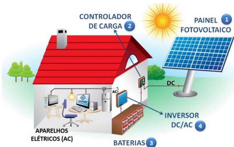
Figura 2.39 – Constituição básica de um sistema fotovoltaico isolado
