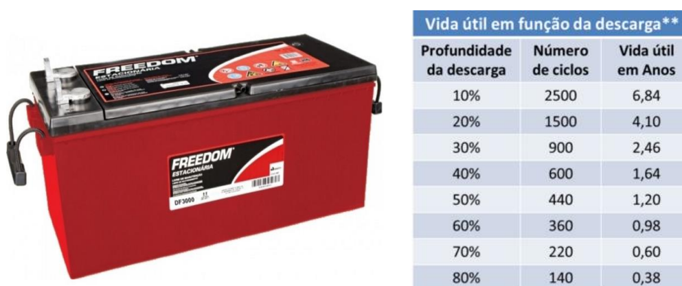
Figura 2.44 – Bateria Estacionária Freedom e vida útil em função da descarga
