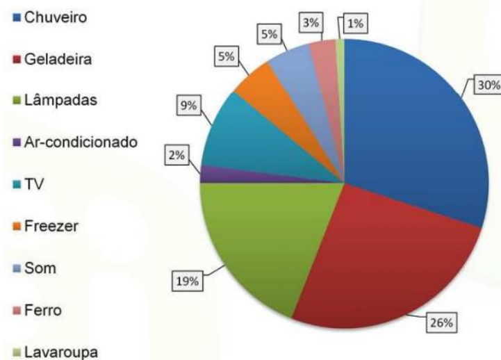
Figura 2.30– Distribuição do consumo de energia em uma residência
