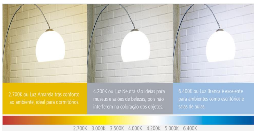
Figura 2.16 – Temperatura de cor para determinados ambientes
