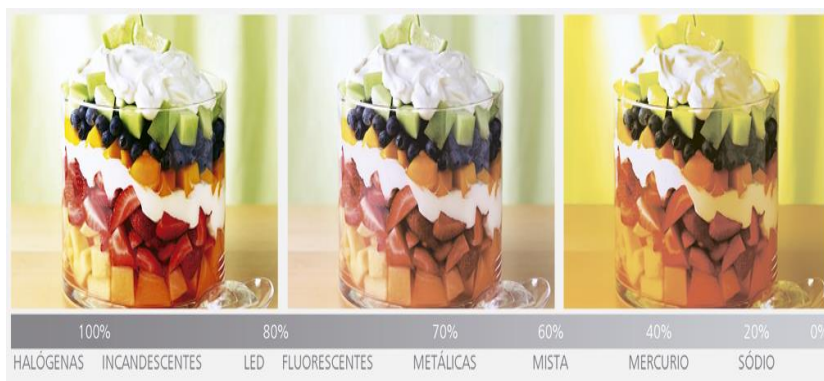
Figura 2.17 – Índice de Reprodução de Cor para determinados tipos de lâmpadas
