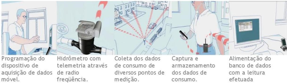
**Figura 18 - Aquisição de dados móvel.**
