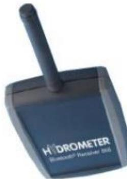
**Figura 17 - Antena receptora.**
