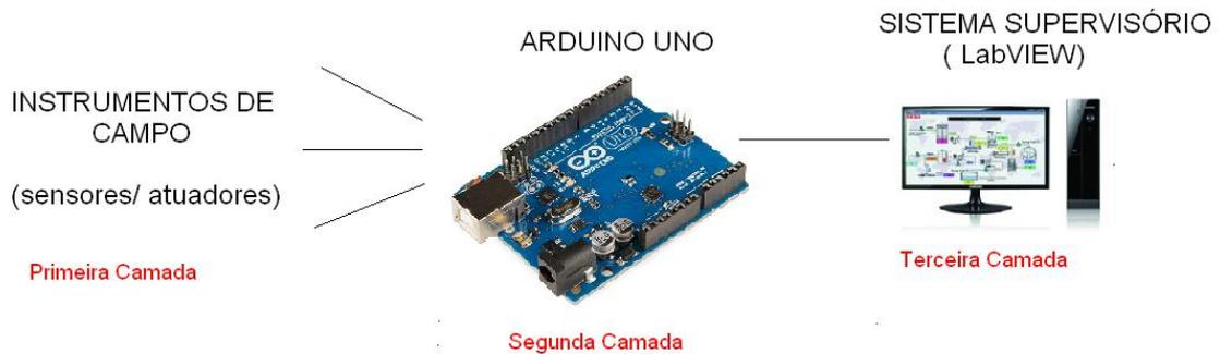
**Figura 45- Sistema de supervisão e controle proposto.**
