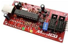
Figura 3.13 - Gravadora MicroICD
