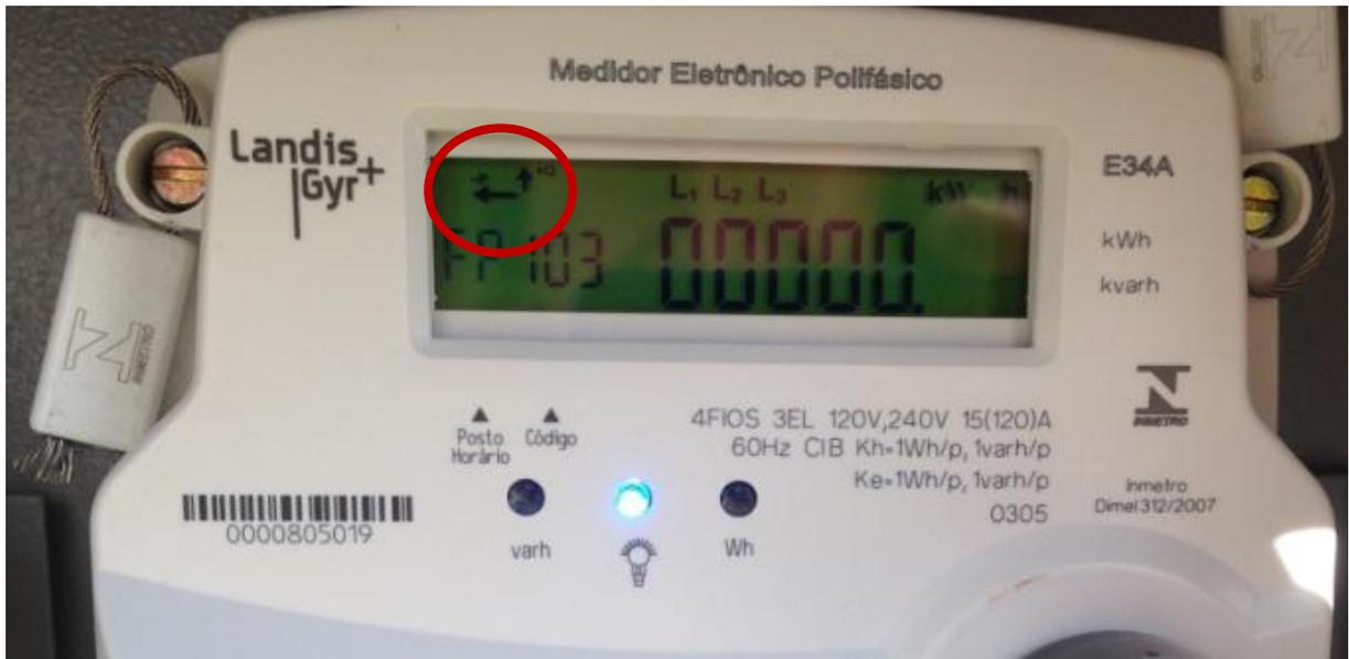
Figura 5.1: – Medidor indicando fluxo reverso de energia
