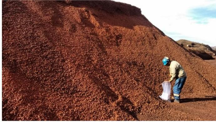
**Figura 13: Supervisor de qualidade efetuando a amostragem por pontos na pilha de estoque dos granulados.**
