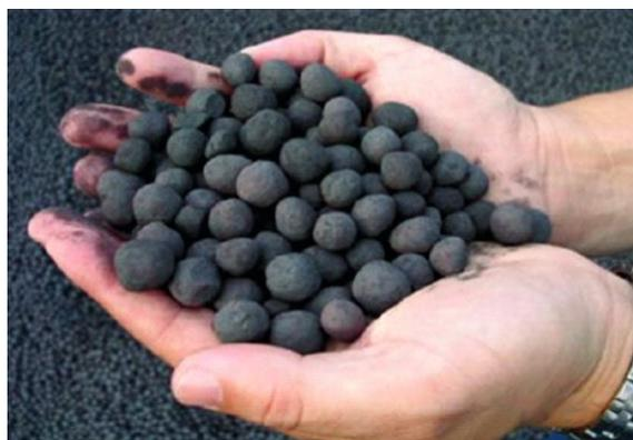
**Figura 10: Pelotas prontas para serem carregadas no alto-forno.**
