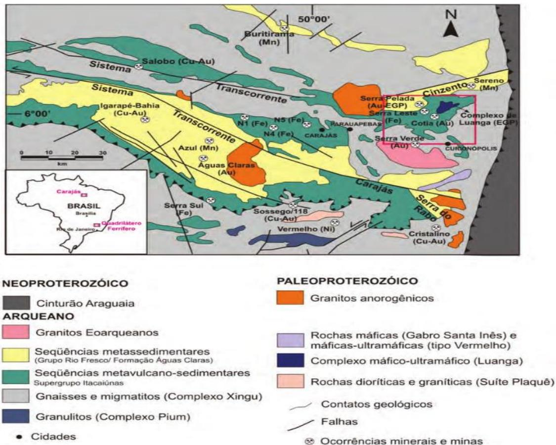
Figura 3: Mapa geológico simplificado da região da Serra dos Carajás e principais depósitos minerais da região.
