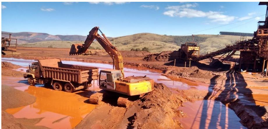
**Figura 20: Retroescavadeira retirando o rejeito pastoso dos canais de sedimentação.**
