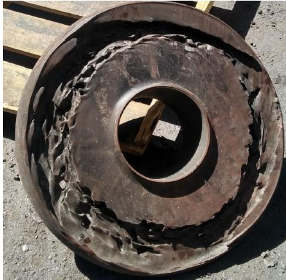
Figura 7 – Revestimento de bomba de polpa desgastada precocemente Fonte: Florencio, Faria e Huebner, 2019.
