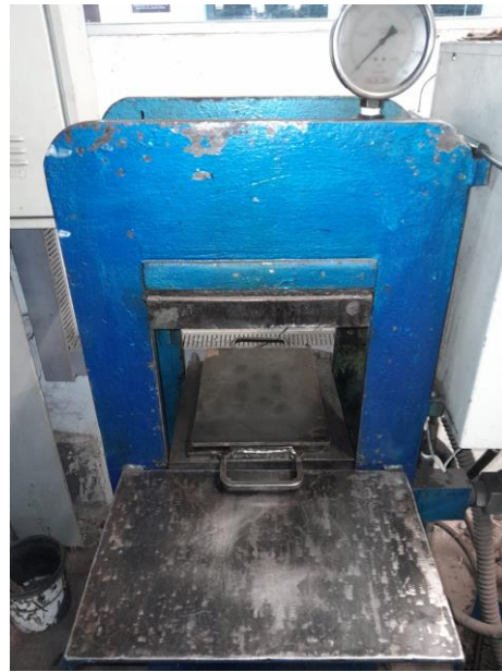
Figura 16 - Prensa e matriz para vulcanização de corpos de prova Fonte: Pesquisa Direta, 2023.
