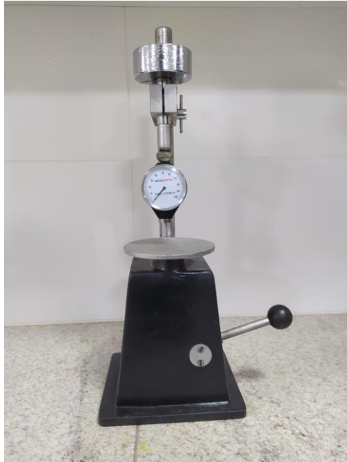
Figura 12 – Durômetro de escala Shore A Fonte: Pesquisa Direta, 2023.
