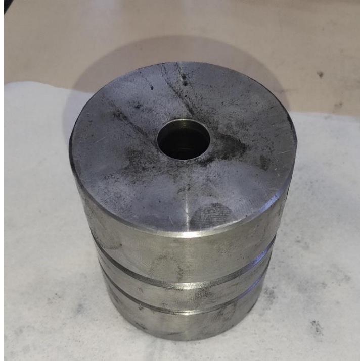
Figura 25: Montagem da base, porta amostras e corpo da matriz. Fonte: Pesquisa direta (2023).
