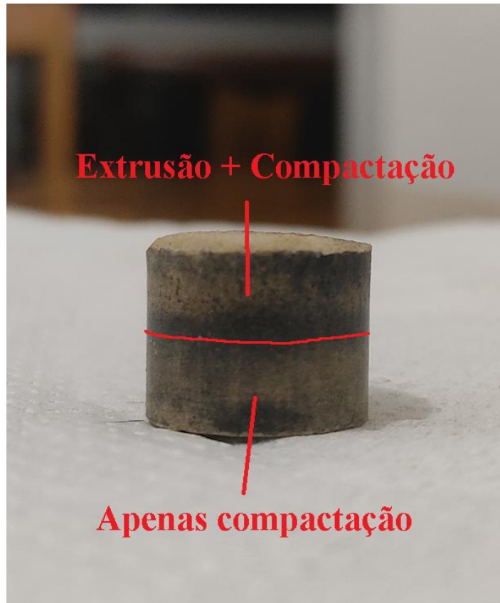
Figura 28: Amostra do segundo método de compactação. Fonte: Pesquisa direta (2023).
