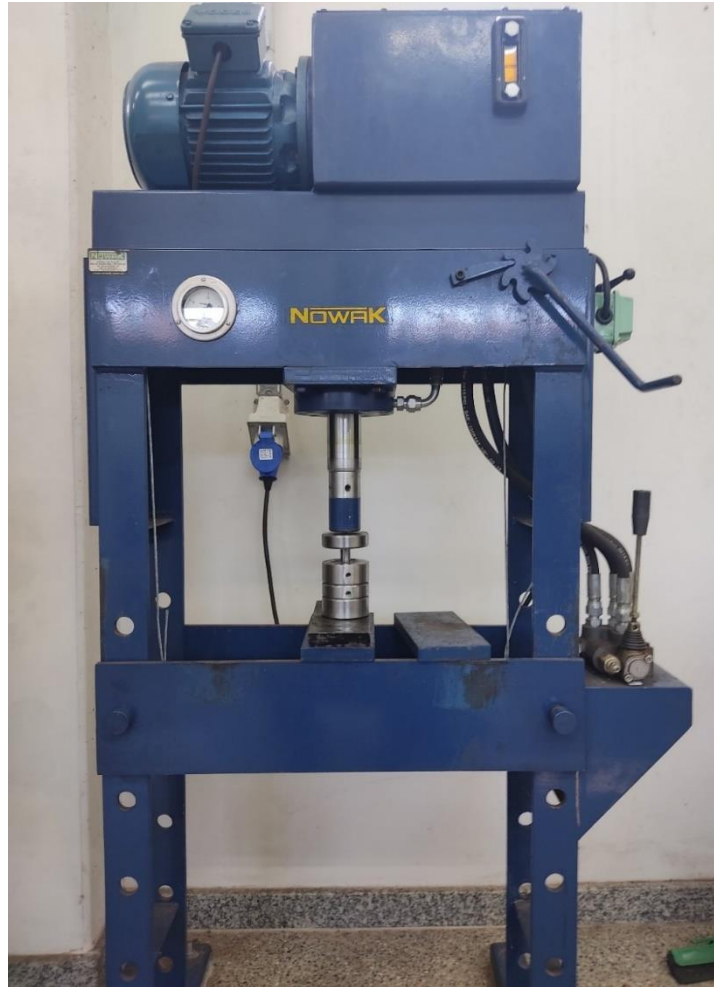
Figura 27: Matriz alocada na prensa hidráulica antes da compactação. Fonte: Pesquisa direta (2023).
