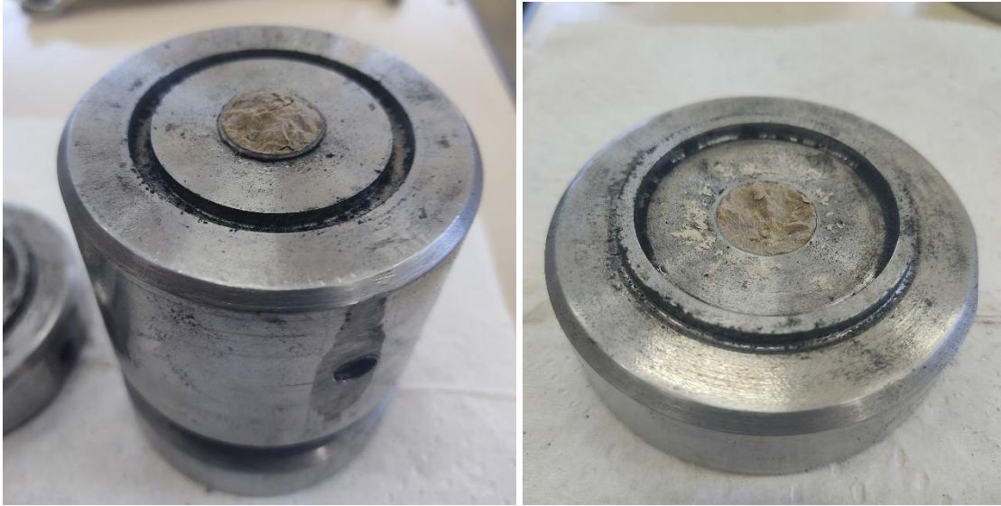
Figura 32: Estrutura guia de punção com extrusão e porta amostras após o terceiro método de compactação.
