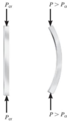
Figura 6: Flambagem. Fonte: Hibbeler (2016).
