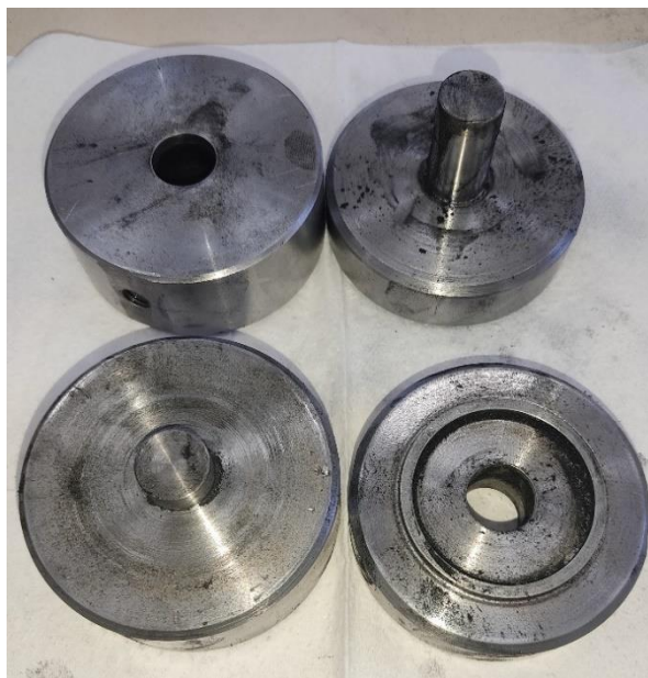
Figura 24: Partes da matriz lubrificadas. Fonte: Pesquisa direta (2023).
