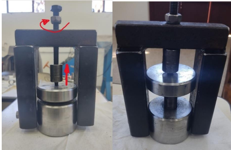
Figura 30: Estrutura guia com extrusão e seu punção montados no mecanismo de separação.
