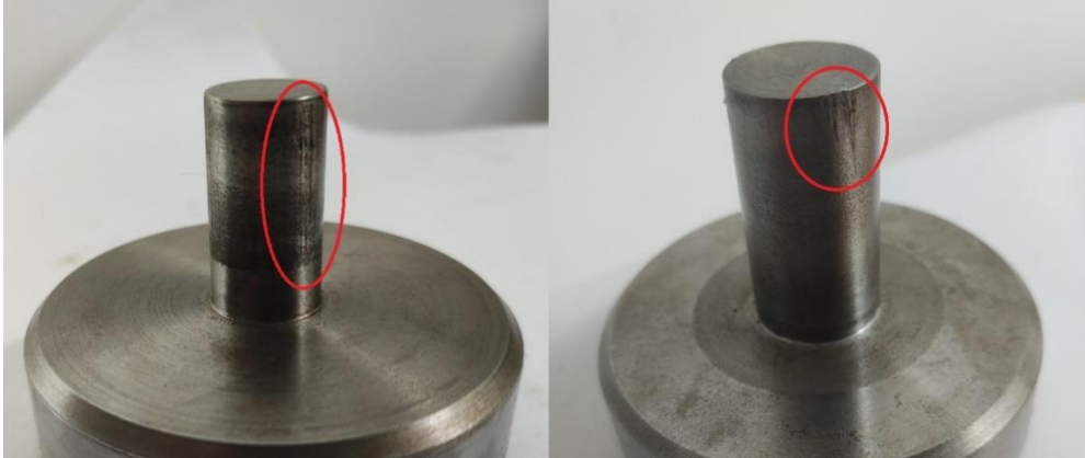
Figura 36: Desgaste nos punções. Fonte: Pesquisa direta (2023).
