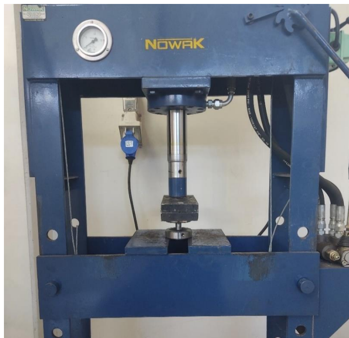
Figura 33: Posição de ejeção de amostra na prensa hidráulica.
