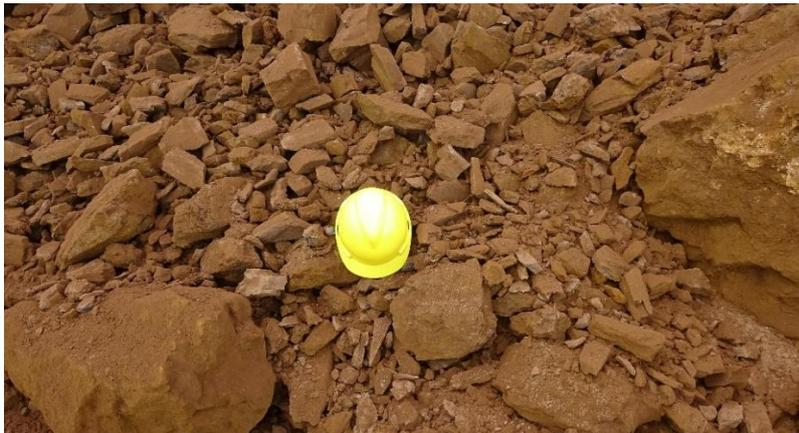
Figura 16: Imagem usada para fazer a análise granulométrica estática.
