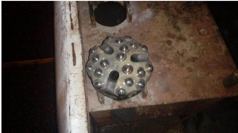
Figura 2: Bit usado nos métodos martelo de superfície e martelo de fundo.
