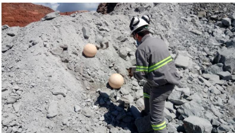
Figura 9: Blaster retirando foto do material desmontado para realizar análise granulométrica estática.
