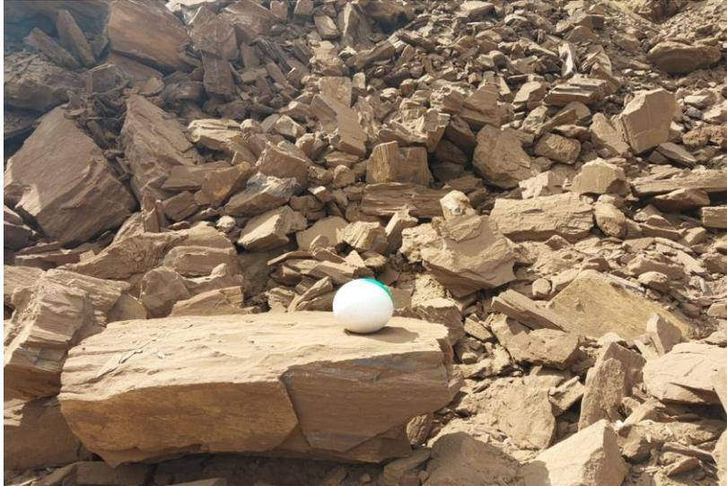
Figura 15: Imagem usada para fazer a análise granulométrica estática.
