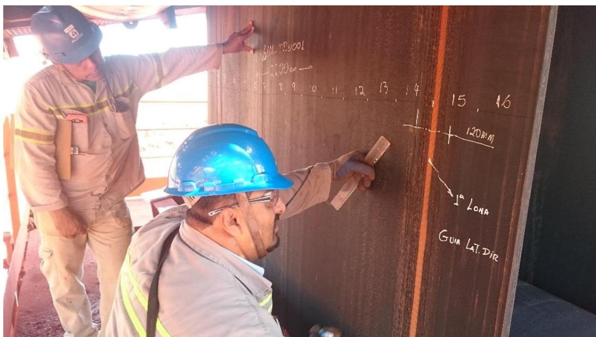
**Figura 4.16** Treinamento de medição de espessura de correias
