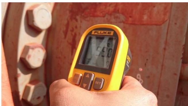
**Figura 4.14** Medição de temperatura
