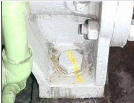
**Figura 4.12** Marcação de parafuso para identificação rápida de inconformidade
