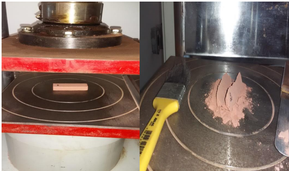
Figura 4.3.7: Corpo de prova antes e depois da realização do teste de compressão.
