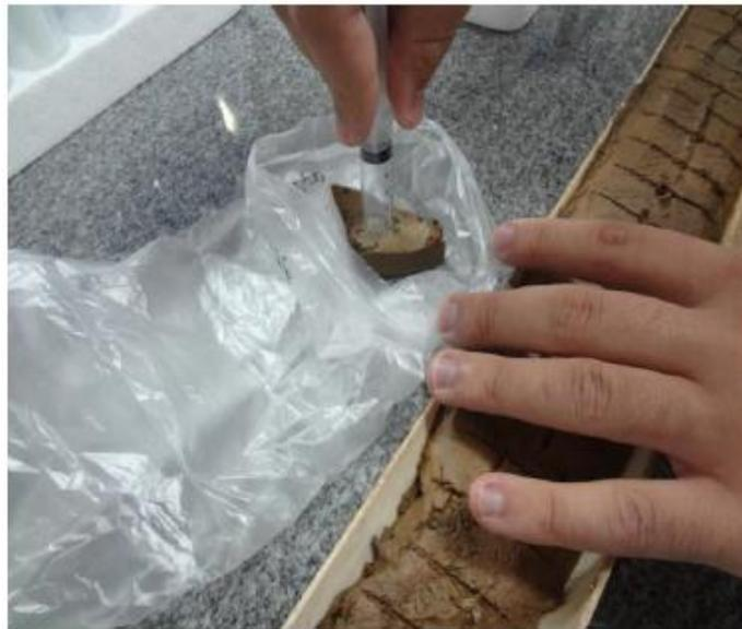
**Figura 10:** Separação de 2cm<sup>3</sup> de cada uma das 25 amostras do testemunho sedimentar do meandro abandonado do rio Maracujá.
