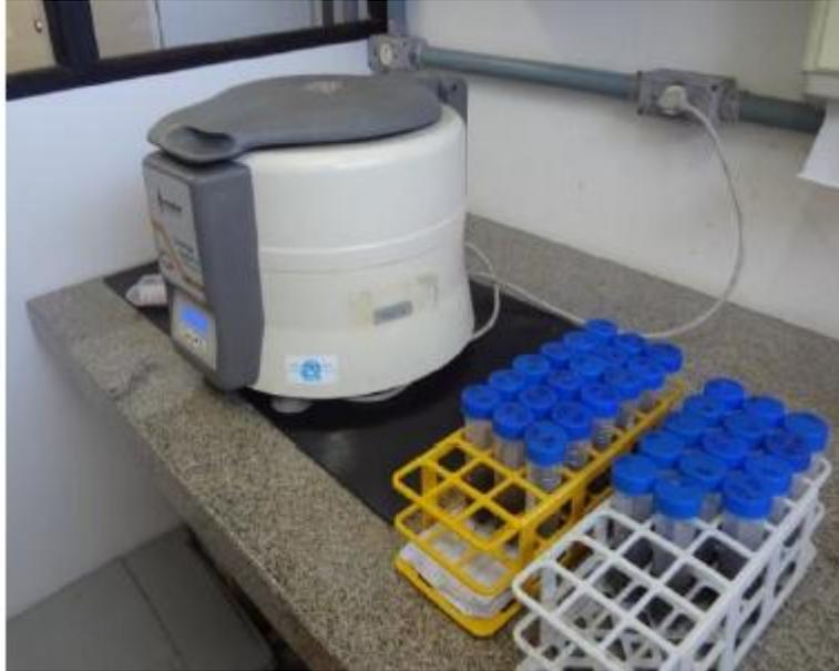
**Figura 12:** Centrifugação das amostras do material do testemunho sedimentar do meandro abandonado do rio Maracujá.
