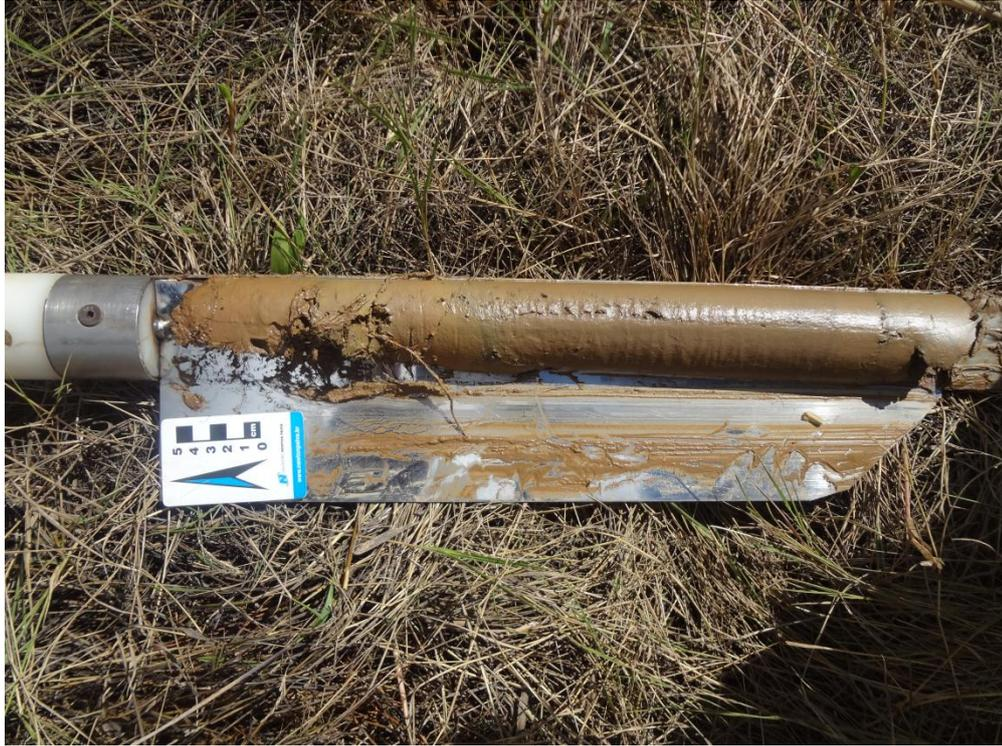
**Figura 8:** Material retirado com auxílio do testemunhador tipo *Russian*.
