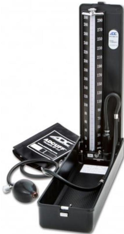
**Figura 8 – Coluna de mercúrio que pode ser utilizada como padrão de medição**
