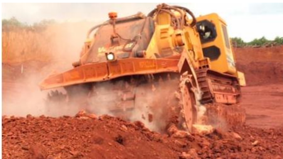
Figura 5.5. Minerador de Superfície Vermeer TL1255 em operação na Mina de bauxita de Juruti (ALCOA, 2017)
