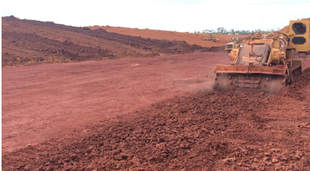
Figura 6.9 Teste de variação de profundidade e velocidade de avanço em uma tira (ALCOA, 2016)
