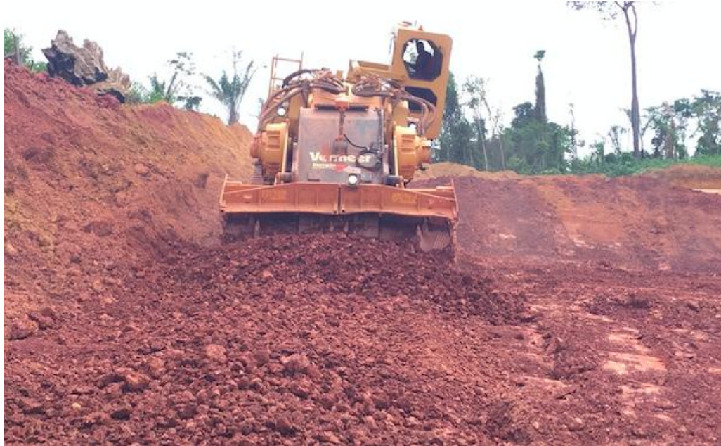
Figura 6.1. Superfície irregular e imperfeita do primeiro corte impactando diretamente a produtividade do equipamento (ALCOA, 2016)
