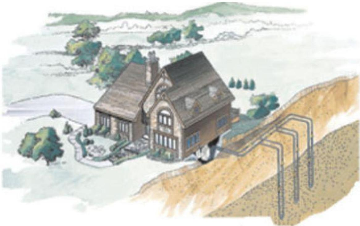
Figura 2.13 - Sistema de ciclo fechado vertical
