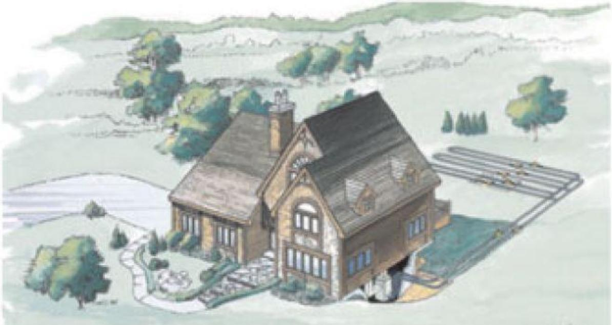
Figura 2.12 - Sistema de ciclo fechado horizontal
